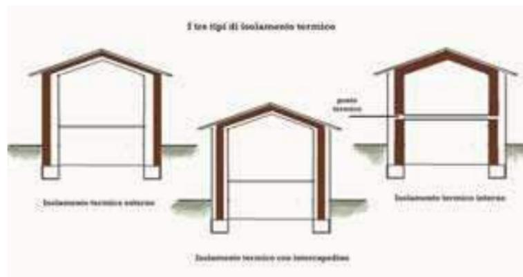
rimanendo più calda in inverno e fresca in estate, generando un maggior confort abitativo. La posa dell'isolante dal lato esterno riduce inoltre significativamente i problemi legati alla formazione di condensa ed alla conseguente comparsa di macchie di umidità e di muffe sulle pareti degli ambienti abitati; vale comunque la pena di sottolineare che il fenomeno è piuttosto
